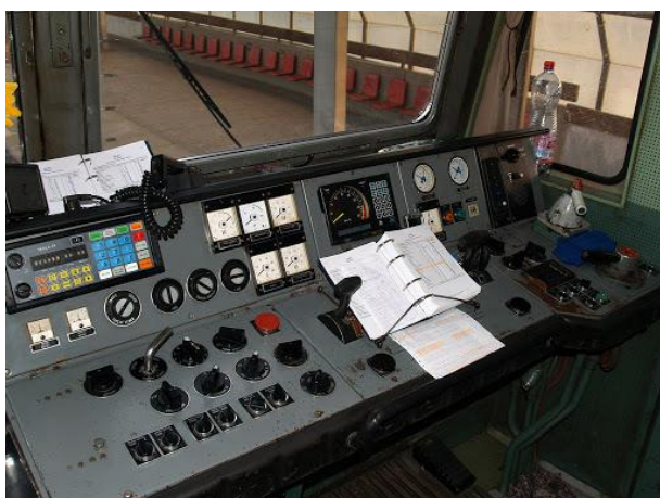
Obrázek 1: Reálné stanoviště Lokomotivy ES 499.1
